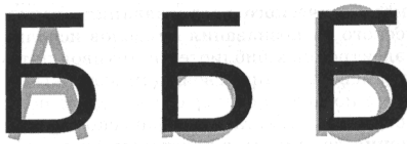
Рис. 3.17. Распознаваемый символ "Б" накладывается на векторные шаблоны символов (А, Б, В и т. д.)
